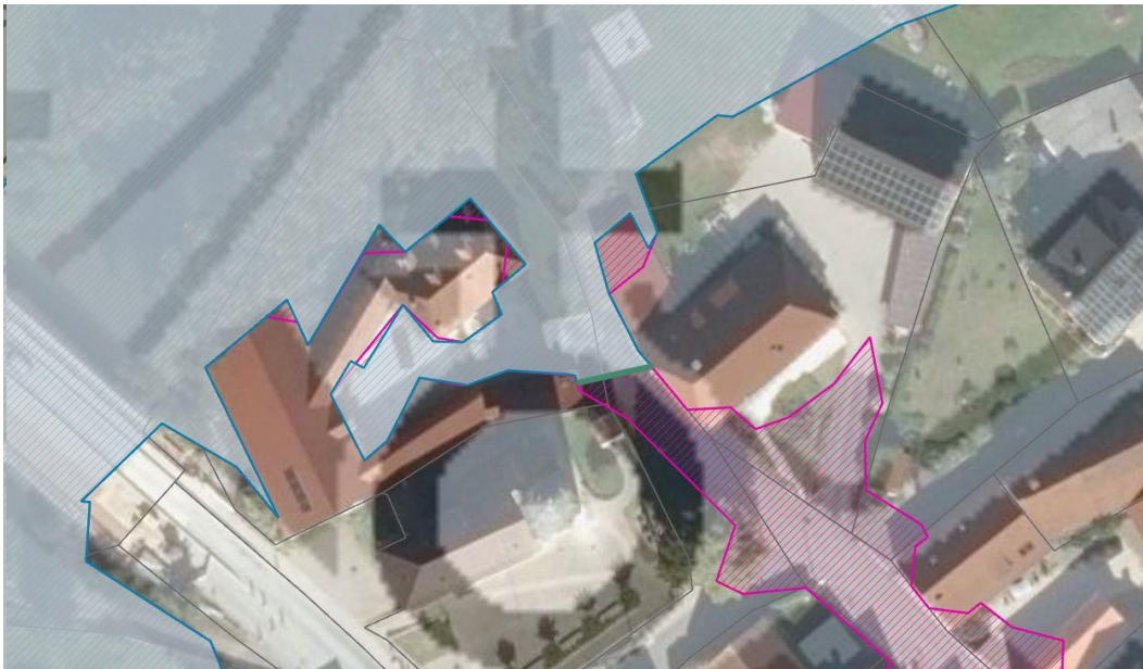
Überschwemmungsfläche bei HQ50: magenta (Ist-Zustand), blau (Plan-Zustand)
