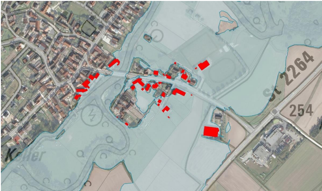
Überschwemmungsfläche und betroffene Gebäude bei HQ50
