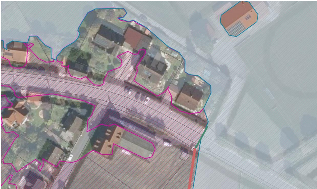
Überschwemmungsfläche bei HQ50: magenta (Ist-Zustand), blau (Plan-Zustand)
